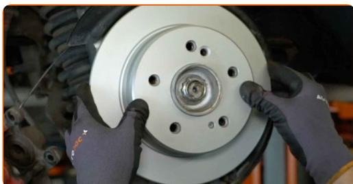
**37** Instale o parafuso de fixação.
