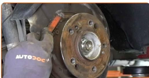
**26** Desmonte o ajustador do travão de estacionamento.
