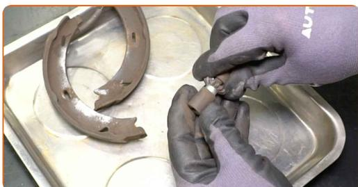
**27** Limpe o ajustador do travão de estacionamento. Use uma escova metálica. Use o spray de limpeza universal.
