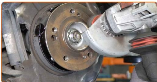
**35** Trate a superfície de contacto. Utilize massa lubrificante de cerâmica.
