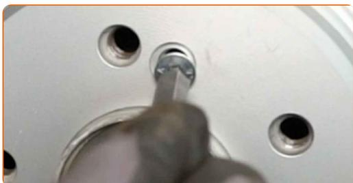
**38** Aperte os fixadores do disco de travão. Use HEX n.º H5. Use uma chave de torque. Aperte-o para o torque de 10 Nm.
