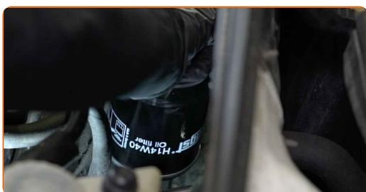
**16** Aperte o filtro de óleo. Lembre-se de se certificar do torque de aperto recomendado. Use o soquete 76/14F. Use uma chave de torque. Aperte-o para o torque de 20 Nm.
