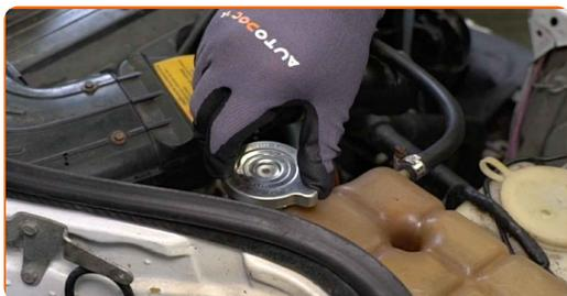
**37** Enrosque a tampa do depósito do líquido de refrigeração.
