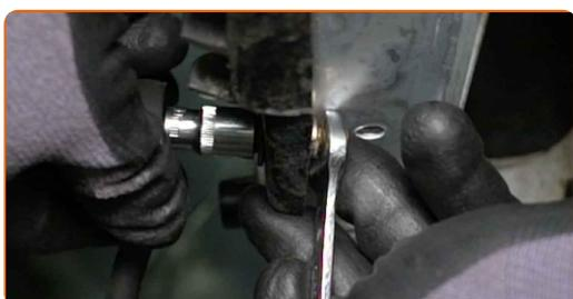
**29** Conecte o tubo inferior do líquido de refrigeração.
