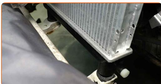
**24** Coloque os cliques superiores do radiador do motor.
