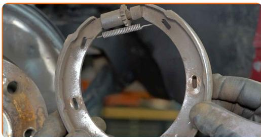
**25** Limpe o parafuso que liga o cabo do travão de estacionamento à manga de eixo traseira. Use uma escova metálica. Use spray WD-40.
