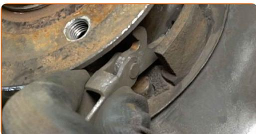
**40** Instale o parafuso de fixação.
