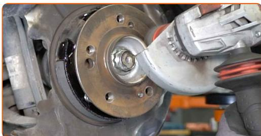
**47** Trate a superfície de contacto. Utilize massa lubrificante de cerâmica.
