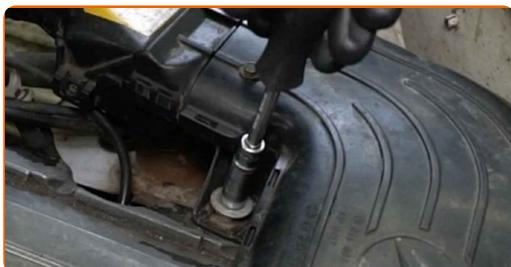
5 Retire os parafusos de fixação.
