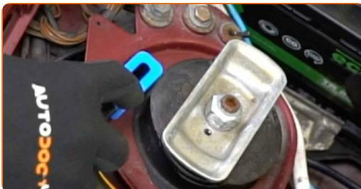
**4** Limpe o elemento de fixação de componentes do amortecedor. Use uma escova metálica. Use spray WD-40.
