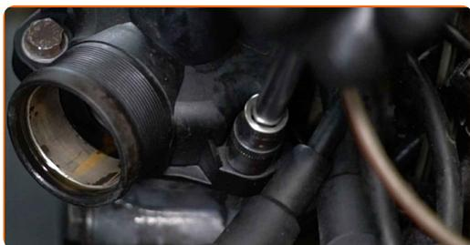
**13** Retire os parafusos de fixação.
