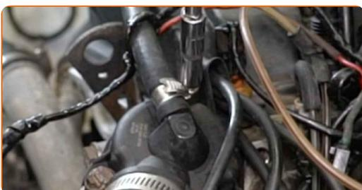
**10** Separe o tubo do depósito de expansão da carcaça do termóstato.
