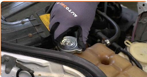
**29** Enrosque a tampa do depósito do líquido de refrigeração.
