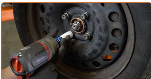
**19** Baixar o carro e trabalhar em ordem transversal, apertar os parafusos das rodas. Use o soquete de impacto para roda #17. Use uma chave de torque. Aperte-o para o torque de 110 Nm.
