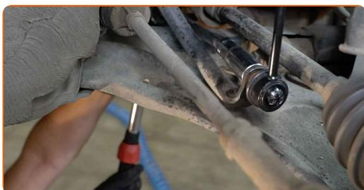
**13** Desaparafuse o fixador que conecta bieleta da barra estabilizadora à barra estabilizadora. Use uma chave combinada nº 17. Use uma chave soquete nº 19. Use uma chave de torque. Aperte-o para o torque de 55 Nm.
