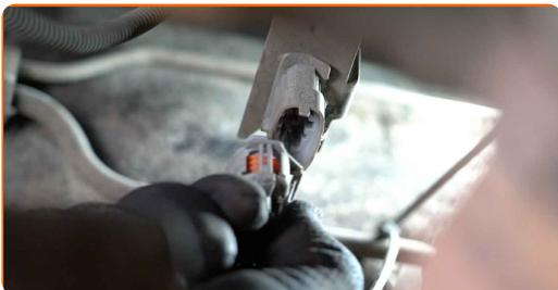
**5** Limpe o fixador do sensor de oxigénio. Use uma escova metálica. Use spray WD-40.
