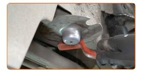
Instale o compressor de mola em conjunto com os suportes de borracha nos locais de montagem.
