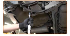
Limpe os elementos de fixação do amortecedor. Use uma escova metálica. Use spray WD-40.
