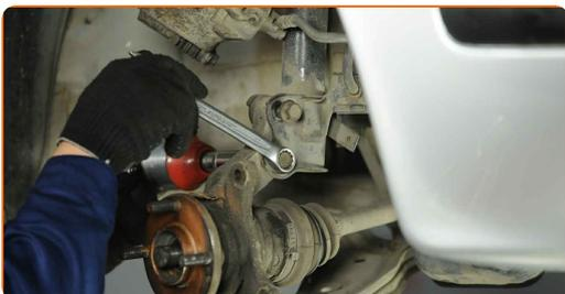
**20** Retire os parafusos de fixação (2 peças).
