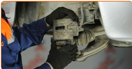
**50** Aperte a braçadeira da pinça do travão. Use uma chave soquete nº 17. Use uma chave de torque. Aperte-o para o torque de 115 Nm.
