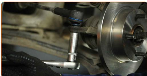
**53** Trate a porca de fixação conectada ao terminal de direção à manga de eixo. Trate os fixadores do amortecedor. Trate os fixadores da rótula de suspensão. Use massa de cobre.
