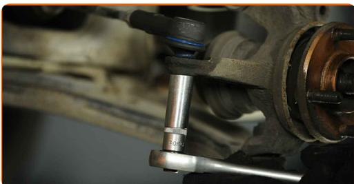
**14** Desconecte o terminal de direção da manga de eixo.
