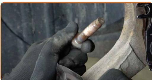
**21** Desligar a manga de eixo do suporte do amortecedor.
