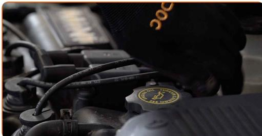
**3** Desaperte a tampa da caixa do filtro em conjunto com o antigo elemento do filtro. Use o soquete 76-14F. Use uma chave de catraca.
