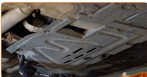
**24** Aperte os parafusos de fixação da tampa de proteção. Use uma chave soquete nº 8. Use uma chave de catraca.
