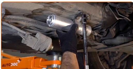
**21** Conecte o regulador de pressão de combustível ao filtro de combustível. Instale o anel de pressão do clipe de retenção do regulador de pressão de combustível.
