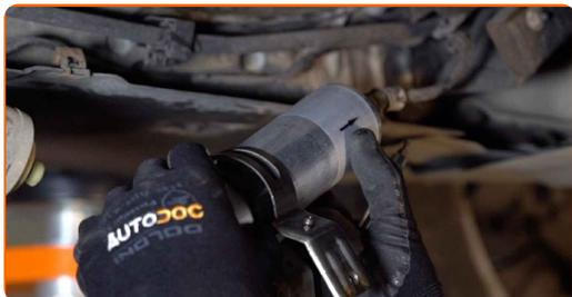
**19** Aperte o fixador do suporte do filtro de combustível. Use Torx T20. Use uma chave de catraca.
