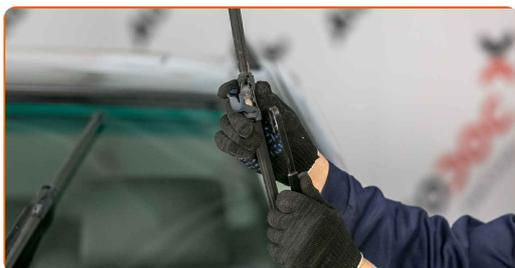
Substituição: escovas do limpa vidros – MINI Hatchback (R50, R53).
