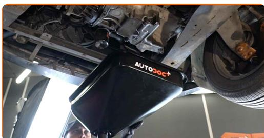
**7** Limpe a área do orifício de drenagem do cárter. Use uma escova metálica. Use o spray de limpeza universal.
