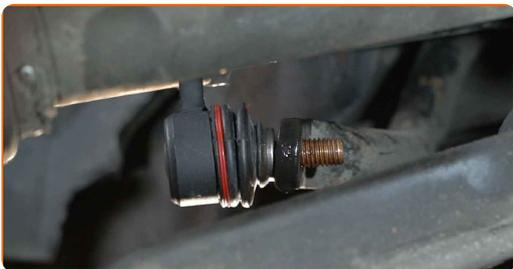
**12** Aperte o fixador da bieleta da barra estabilizadora. Use uma chave combinada nº 17. Use uma chave soquete nº 17. Use uma chave de catraca.
