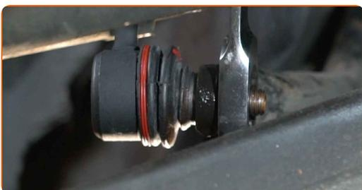
**13** Desparafuse o fixador que conecta bieleta da barra estabilizadora à barra estabilizadora. Use uma chave combinada nº 17. Use uma chave soquete nº 17. Use uma chave de torque. Aperte-o para o torque de 48 Nm.
