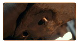
Aparafuse o fixador que liga a junta esférica ao braço de controlo. Use uma chave combinada nº 17. Use uma chave soquete nº 17. Use uma chave de catraca.
