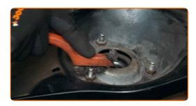
Solte os fixadores superiores do dispositivo amortecedor (3 peças). Use uma chave soquete nº 13. Use uma chave de catraca.
