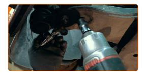
Aperte os fixadores que ligam a junta esférica ao braço de suspensão. Use uma chave soquete nº 17. Use uma chave de torque. Aperte-o para o torque de 48 Nm.
