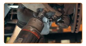
Retire os parafusos de fixação.
