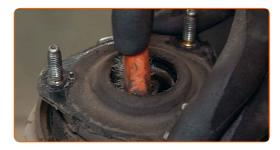
Desaparafuse a porca do eixo do pistão da suspensão. Use uma chave soquete nº 19. Use HEX n.º H6. Use uma chave de catraca.
