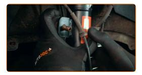
Aperte o fixador da bieleta da barra estabilizadora. Use uma chave soquete nº 17. Use uma chave de catraca.
