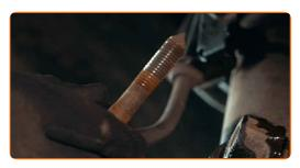
Desaperte o fixador que liga o eixo de transmissão ao cubo de roda. Use uma chave soquete nº 32. Use uma chave de catraca.
