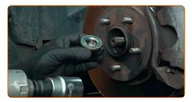
Limpe os fixadores que conectam a rótula de suspensão ao braço da suspensão. Use uma escova metálica. Use spray WD-40.
