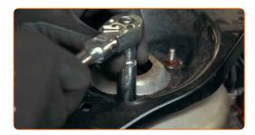
Limpe os fixadores do eixo motor. Use uma escova metálica. Use spray WD-40.
