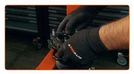
Aperte a porca do suporte do amortecedor da haste do pistão. Use uma chave soquete nº 19. Use HEX n.º H6. Use uma chave de torque. Aperte-o para o torque de 55 Nm.
