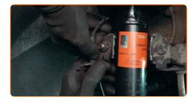
Trate os fixadores do amortecedor. Trate os fixadores da manga de eixo. Use massa de cobre.
