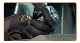
Desligar a manga de eixo do suporte do amortecedor.
