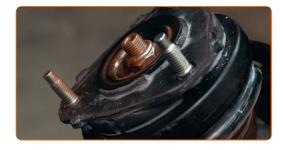
Instale o amortecedor no arco da roda.
