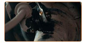
Limpe o fixador inferior que liga o dispositivo amortecedor à manga de eixo. Use uma escova metálica. Use spray WD-40.
