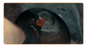
Trate a haste da coluna do amortecedor. Use massa de cobre.
