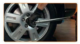
Apertar os parafusos da roda usando um padrão cruzado. Use o soquete de impacto para roda #19. Use uma chave de torque. Aperte-o para o torque de 90 Nm.
