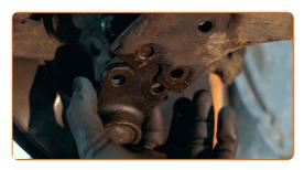
Instale os parafusos de fixação.
