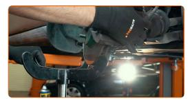
Solte o fixador inferior que conecta a coluna de suspensão às mangas de eixo. Use uma chave especial para remover o amortecedor. Use uma chave de catraca.
