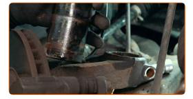
Desaperte os fixadores superiores da coluna de suspensão (3 peças).
