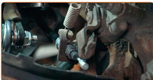
**22** Ajuste a tensão do cabo do travão de estacionamento. Use uma chave soquete nº 16. Use uma chave de catraca.
