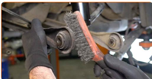
**54** Limpe os assentos de montagem da coluna do amortecedor. Use uma escova metálica. Use spray WD-40.
