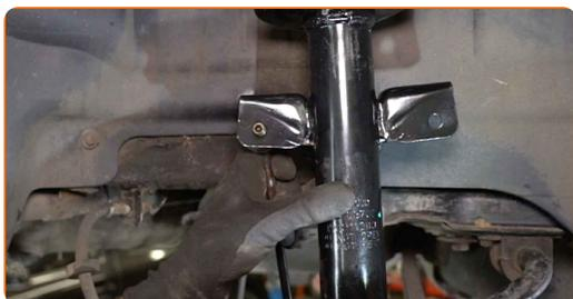
**74** Aperte o fixador da bieleta da barra estabilizadora. Use uma chave soquete nº 17. Use uma chave de catraca.
