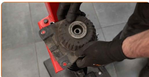
**45** Aperte a porca do suporte do amortecedor da haste do pistão. Use uma chave soquete nº 19. Use HEX n.º H6. Use uma chave de torque. Aperte-o para o torque de 50 Nm.
