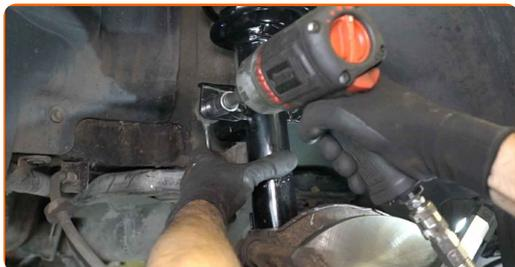
**75** Desaparafuse o fixador que conecta bieleta da barra estabilizadora à barra estabilizadora. Use uma chave soquete nº 17. Use uma chave de torque. Aperte-o para o torque de 48 Nm.
