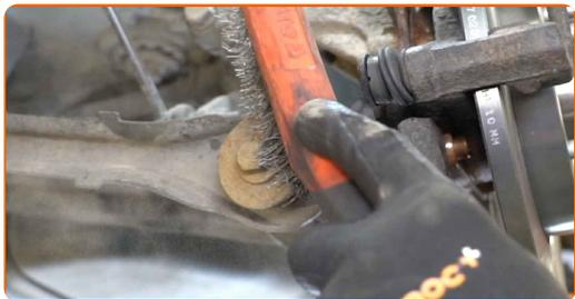
**15** Desaparafuse o fixador que conecta o braço de controlo à manga traseira. Use uma chave soquete nº 15. Use uma chave de catraca.
