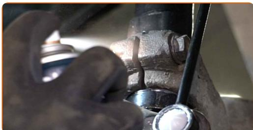
**77** Trate a superfície onde o disco de travão entra em contacto com o aro da roda. Use massa de cobre.
