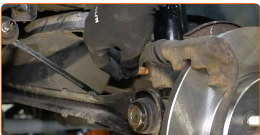
**57** Aparafuse o fixador que liga o amortecedor à manga de eixo traseira. Use uma chave soquete nº 18. Use uma chave de catraca.
