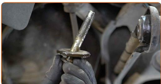
**17** Limpe todas as juntas do braço. Use uma escova metálica. Use spray WD-40.
