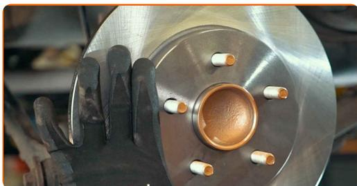
**33** Aparafuse o fixador do disco de travão.
