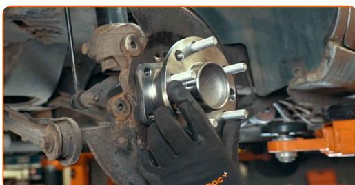
**27** Aperte os parafusos do cubo de roda. Use Torx T50. Use uma chave de torque. Aperte-o para o torque de 70 Nm.
