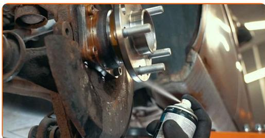
**29** Trate do conector do sensor de ABS. Use spray eletrônico.
