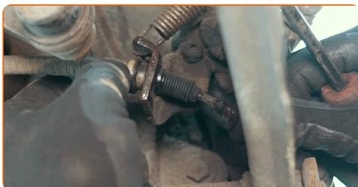
**8** Limpe os elementos de fixação da pinça de travão. Use uma escova metálica. Use o spray de limpeza universal.
