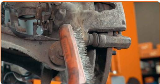
**9** Desaparafuse a fixação de pinça de travão. Use uma chave combinada nº 13.
