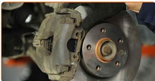
**38** Trate a superfície onde o disco de travão entra em contacto com o aro da roda. Utilize massa lubrificante de cerâmica.
