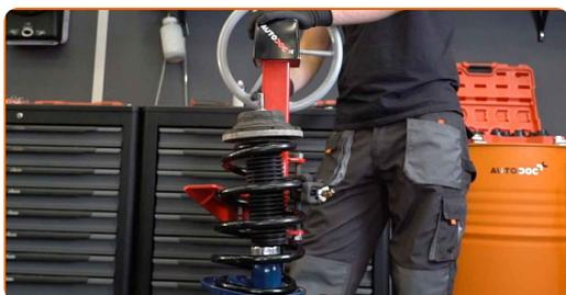
**56** Retire a coluna de suspensão montada.
