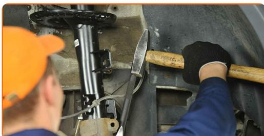
24 Desligar a manga de eixo do suporte do amortecedor.
