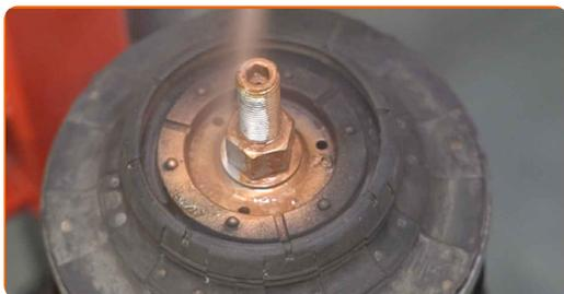
**58** Limpe os assentos de montagem da coluna do amortecedor. Use uma escova metálica. Use spray WD-40.
