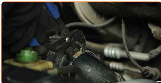
**32** Desconecte o tubo de entrada de ar do compartimento do filtro de ar.
