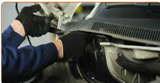
64 Aperte os parafusos de montagem da cobertura protetora. Use Torx T30. Use uma chave de catraca.
