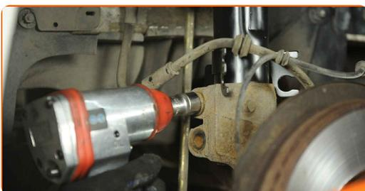
22 Retire os parafusos de fixação.
