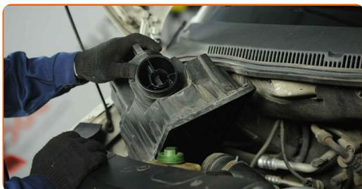
68 Conecte o tubo de entrada de ar ao compartimento do filtro de ar.
