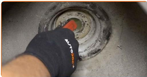
**59** Instale o amortecedor no arco da roda.
