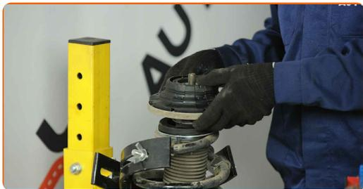
**54** Aperte a porca do suporte do amortecedor da haste do pistão. Use uma chave soquete n° 21. Use HEX n.º H7. Use uma chave de torque. Aperte-o para o torque de 80 Nm.
