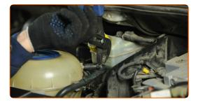
Fixe o conector do tanque de expansão do líquido de arrefecimento.
