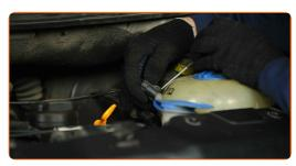
Solte a braçadeira de fixação da mangueira do líquido de refrigeração. Utilize alicates de anel clic-R.
