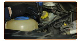
Separe a mangueira do depósito de refrigeração. Use uma chave de fenda plana.
