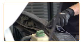
Remova os clipes da tampa do motor. Use uma chave de fenda plana.
