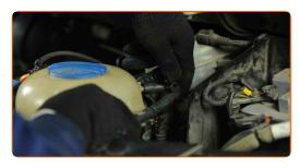
Fixe a braçadeira de fixação da mangueira do líquido de refrigeração. Utilize alicates de anel clic-R.
