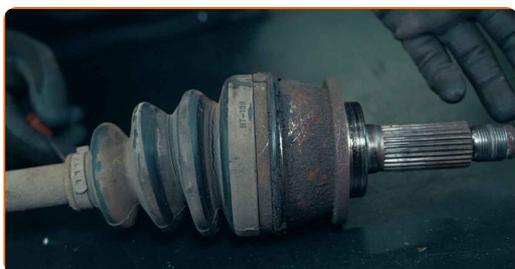
**35** Use um extrator e a porca do eixo para desmontar a junta homocinética do semieixo
