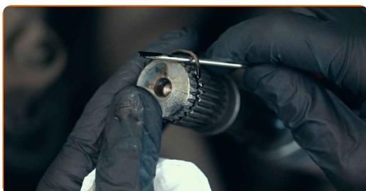
**9** Retire o fole e limpe a massa lubrificante usada da junta homocinética
