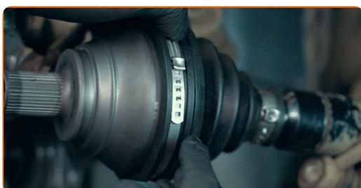
**34** A desmontagem deste tipo de junta homocinética pode requerer uma ferramenta específica
