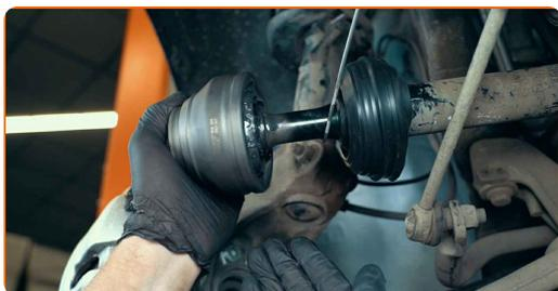
**32** Desengordure a superfície da carcaça da junta homocinética e coloque o fole cuidadosamente
