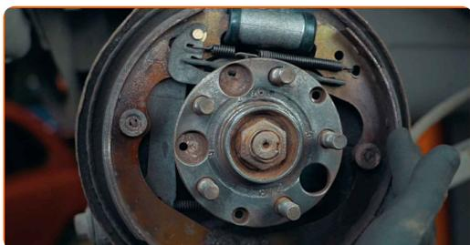
**12** Aceda aos fixadores do cabo; dependendo da conceção, pode ser necessário remover primeiro os calços de roda
