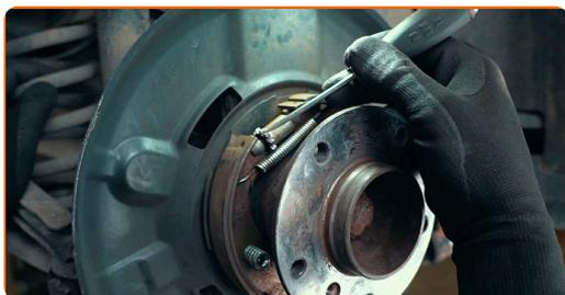
**8** Poderá aceder à engrenagem do ajustador através do orifício do parafuso da roda ou do orifício no cubo
