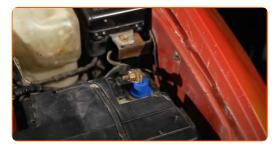
Desconecte o conector do medidor.
