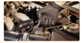
Ao desmontar o medidor da massa de ar, deve retirar os componentes adjacentes, como a braçadeira de fixação de mangueira ou o filtro de ar.
