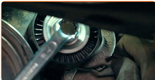
**12** Verifique se o tensor e as polias se movem livremente e verifique o estado da polia de roda livre do alternador, da polia amortecedora da cambota e de todas as outras polias
