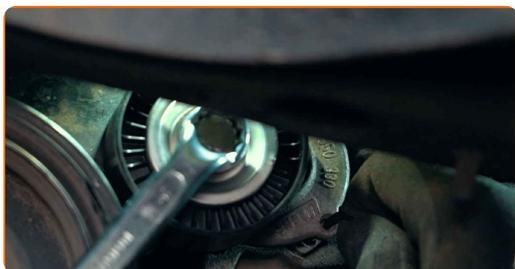
**16** Verifique se o tensor e as polias se movem livremente e verifique o estado da polia de roda livre do alternador, da polia amortecedora da cambota e de todas as outras polias
