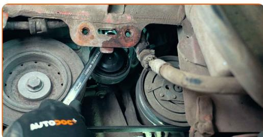
**21** Se o tensor for mecânico, verifique a deflexão da correia pressionando a secção longa entre as polias
