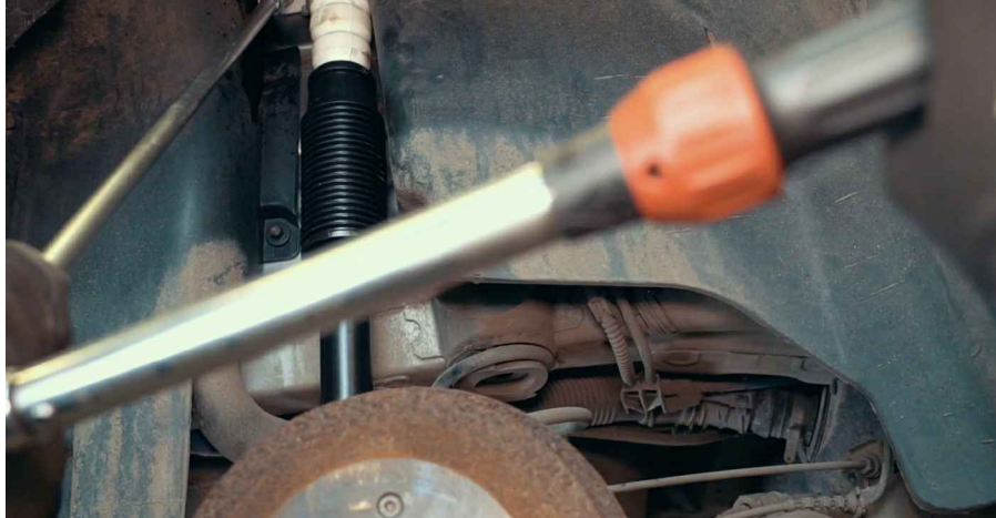
Substituição do folo antipeira e do batente numa torre de suspensão
