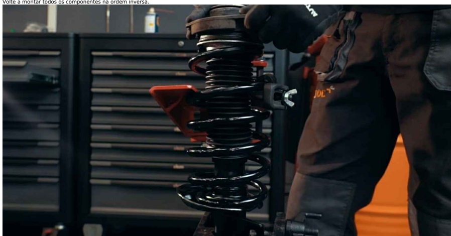
Importante! • Preste atenção à posição de montagem do suporte para assegurar que está virado na direção correta
