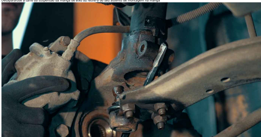
Substituição do folo antipeira e do batente numa torre de suspensão
