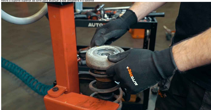
Por favor tenha em atenção! • O batente pode ser instalado no eixo do pistão ou fixado ao suporte • O fole antipoeira pode ser montado no batente, instalado entre a mola e o suporte ou fixado ao suporte.
