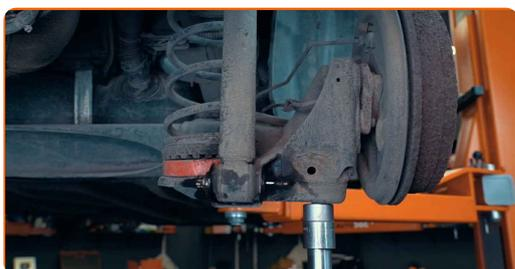
**5** Desaperte o parafuso inferior, mas não o desmonte. Isto irá manter o amortecedor seguro
