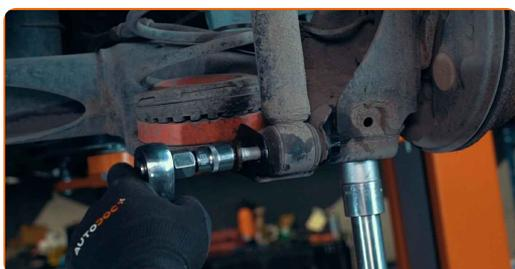
**6** Desenrosque e desmonte o elemento de fixação superior, depois desmonte o parafuso inferior e desmonte o amortecedor
