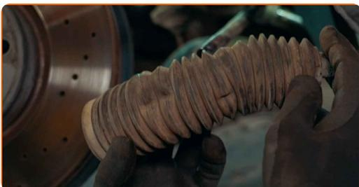
**13** Limpe o eixo de direção de lubrificante e sujidade antiga e aplique um pouco de lubrificante novo
