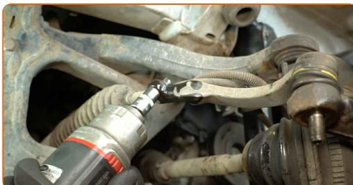
**9** Medir e anotar o comprimento da parte exposta da rosca da barra de direção ou o número de voltas que o terminal da barra de direção realizou ao ser desenroscado para evitar o desalinhamento da roda durante a remontagem. Utilizar um paquímetro.
