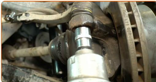
**8** Desapertar o parafuso que fixa o terminal da barra de direção à barra de direção. Utilizar uma chave de caixa de 13 mm. Utilizar uma chave de roquete.
