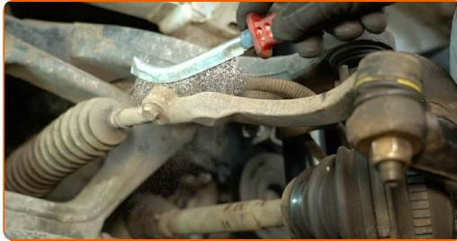
**7** Desenroscar a porca que liga o terminal da barra de direção à manga de eixo. Utilizar uma chave de caixa de 22 mm. Utilizar uma chave de roquete.
