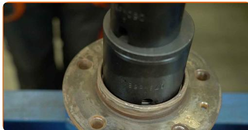
**Substituição: rolamento da roda – NISSAN Interstar Camião de plataforma/Chassis. Os profissionais recomendam:**
