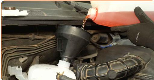
Substituição: depósito de água – NISSAN Interstar Van (X70). AUTODOC recomenda:
