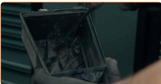
**12** Insira um novo elemento de filtro na caixa do filtro. Certifique-se de que a borda do filtro encaixa-se perfeitamente na caixa.
