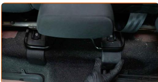
**43** Instale os parafusos de fixação.
