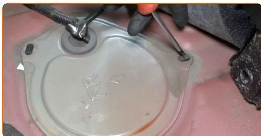
**19** Desmonte a tampa de acesso ao módulo da bomba de combustível. Use uma ferramenta de remoção de clipe.
