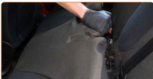
**9** Desmonte as coberturas de plástico das calhas dos bancos traseiros. Use uma ferramenta de remoção de clipe.
