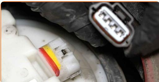
**22** Desmonte o tubo de combustível do módulo da bomba de combustível. Use alicates de linha de combustível.
