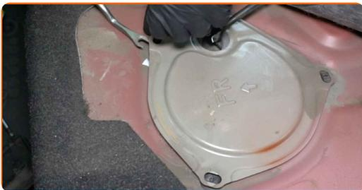
**20** Limpe o local de montagem do módulo da bomba de combustível. Use o spray de limpeza universal.
