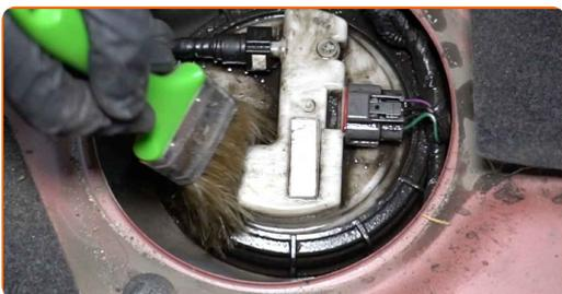
**21** Separe o conector do módulo da bomba de combustível.
