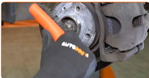
**7** Desaperte o fixador que liga o eixo de transmissão ao cubo de roda. Use uma chave soquete nº 30. Use uma chave de tarraxa.
