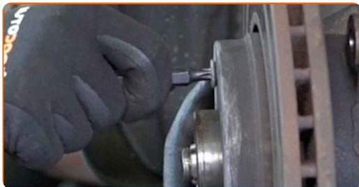
**65** Aperte os fixadores do disco de travão. Use Torx T40. Use uma chave de torque. Aperte-o para o torque de 10 Nm.
