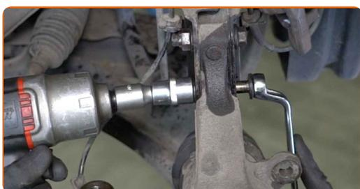
**28** Retire os parafusos de fixação.
