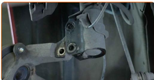
**33** Remova a manga do eixo juntamente com o cubo de roda.
