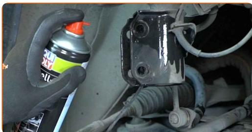
**45** Limpe o fixador da cabeça da barra da direção. Use uma escova metálica. Use o spray de limpeza universal.
