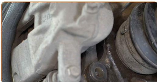
**67** Instale os parafusos de fixação.
