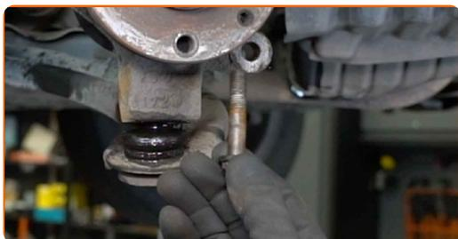
**26** Limpe os fixadores que conectam as colunas de suspensão às mangas de eixo. Use uma escova metálica. Use spray WD-40.
