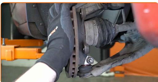
**64** Instale os parafusos de fixação.
