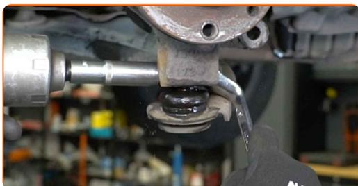
**25** Remova o parafuso de fixação.
