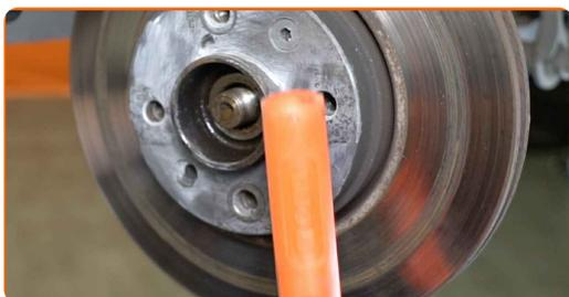
**15** Desenrosque os fixadores do disco de travão. Use Torx T40. Use uma chave de fenda de impacto.
