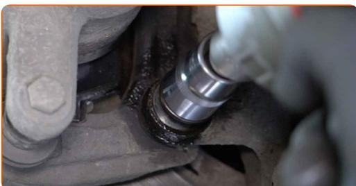
**12** Retire os parafusos de fixação.
