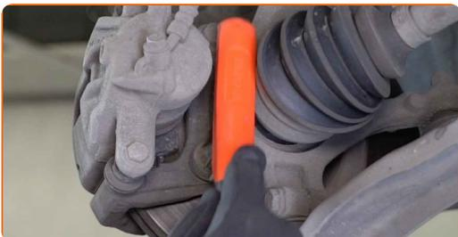
**11** Desaperte os parafusos do suporte da pinça do travão. Use uma chave soquete nº 17. Use uma chave de catraca.
