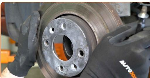
**18** Limpe o elemento fixador do sensor ABS. Utilize uma escova de limpeza de nylon. Use o spray de limpeza universal.
