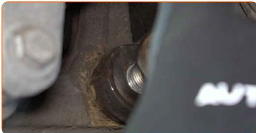
**68** Aperte os parafusos do suporte da pinça do travão. Use uma chave soquete nº 17. Use uma chave de torque. Aperte-o para o torque de 105 Nm.
