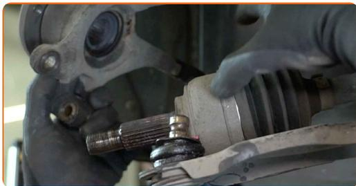
**32** Desconecte a manga do eixo do dispositivo amortecedor.
