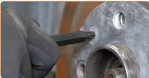
**16** Retire os parafusos de fixação.
