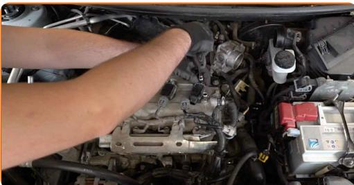
**15** Retire a bobina de ignição do orifício da vela de ignição.
