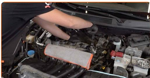
**20** Ligue o conector da bobina de ignição.
