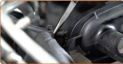
**10** Desaparafuse os fixadores do coletor de admissão. Use uma chave soquete nº 10. Use uma chave de catraca.
