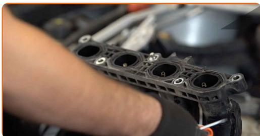
22 Remova a junta do coletor de admissão. Use uma chave de fenda plana.
