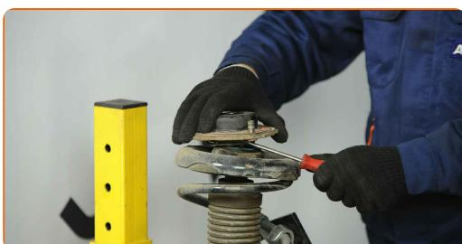
**Substituição: cabeçotes do amortecedores – NISSAN MURANO (Z50).**
