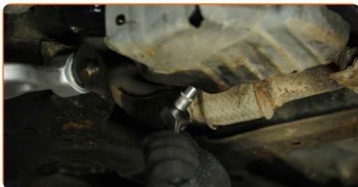
**10** Limpe a área do orifício de drenagem do cárter. Use o spray de limpeza universal.
