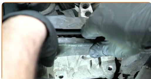
**35** Desaperte os fixadores de apoio do motor. Use uma chave combinada nº 10. Use uma chave soquete nº 10. Use uma chave de catraca.
