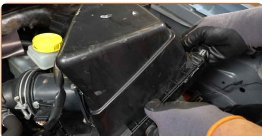
**5** Remova o elemento filtrante da tampa do filtro do ar.
