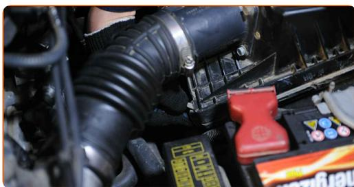
**9** Desaperte os parafusos de fixação do suporte do filtro de combustível. Use uma chave soquete nº 10. Use uma chave de catraca. Use a chave Phillips.
