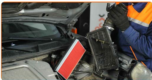
**6** Desconecte a mangueira de ventilação do cárter do tubo de ventilação.
