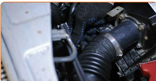
**31** Ligue a mangueira de ventilação do cárter ao tubo de ventilação.
