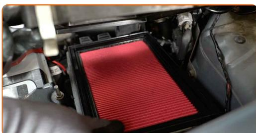
**Substituição: filtro de ar – NISSAN PICK UP (D21). Conselho:**
