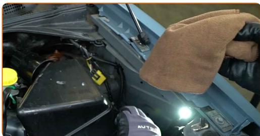
**9** Insira um novo elemento de filtro na caixa do filtro. Certifique-se de que a borda do filtro encaixa-se perfeitamente na caixa.
