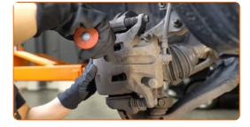
Limpe os elementos de fixação da pinça de travão. Use uma escova metálica. Use spray WD-40.
