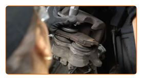
Instale a pinça do travão e fixe-o. Use uma chave combinada nº 17. Use uma chave soquete nº 14. Use uma chave de torque. Aperte-o para o torque de 34 Nm.
