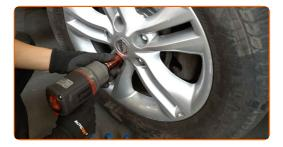
Baixar o carro e trabalhar em ordem transversal, apertar os parafusos das rodas. Use o soquete de impacto para roda #21. Use uma chave de torque. Aperte-o para o torque de 112 Nm.
