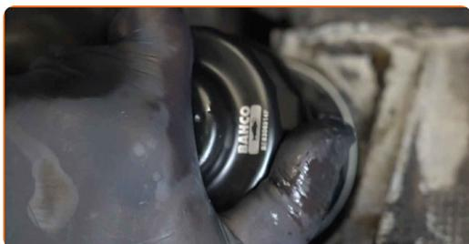
**16** Aperte o filtro de óleo. Lembre-se de se certificar do torque de aperto recomendado. Use o soquete 65-14F. Use uma chave de torque. Aperte-o para o torque de 24 Nm.
