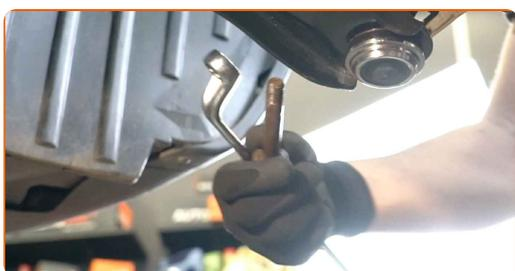
**17** Desconecte os fios do sensor ABS. Use uma ferramenta de remoção de clipe.
