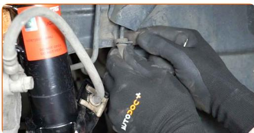
**18** Remova a cobertura do arco da roda. Use uma ferramenta de remoção de clipe.
