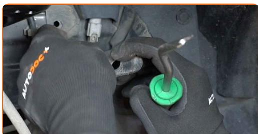
**19** Separe o conector do sensor ABS. Use uma ferramenta de remoção de clipe.
