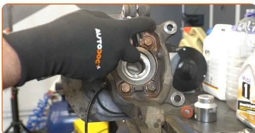
**44** Solte o torno e remova o cubo de roda juntamente com o rolamento.
