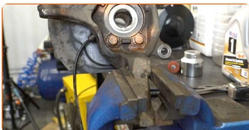
**45** Instale a manga de eixo com um cubo na montagem.
