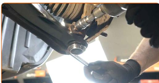
**16** Remova o parafuso de fixação.
