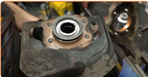
**37** Instale o novo cubo da roda com um rolamento.
