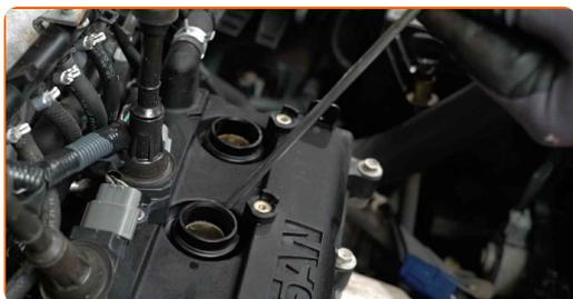
**7** Desaperte as velas de ignição. Use o soquete da vela de ignição #16. Use uma chave de catraca.
