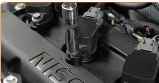
**4** Retire os parafusos de fixação.
