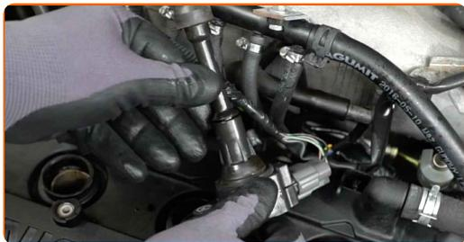
**6** Limpe a sujidade, poeira e detritos de dentro dos poços das velas de ignição.
