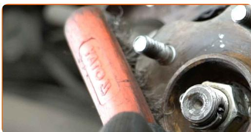
**20** Trate a superfície de contacto. Utilize massa lubrificante de cerâmica.
