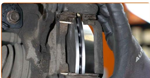
**26** Instale os parafusos de fixação.
