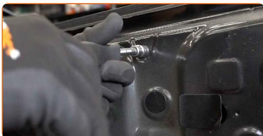
**18** Desmonte a cablagem do vidro elétrico.
