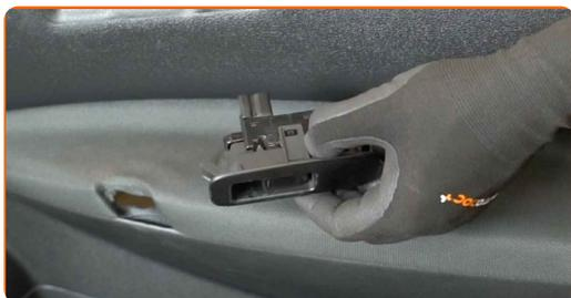
**8** Fixe o conector do vidro elétrico ao módulo do interruptor.
