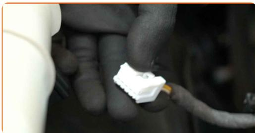
**7** Remova o módulo do interruptor do vidro elétrico.
