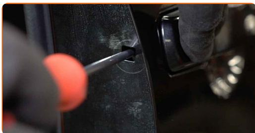
**33** Monte a tampa do elemento fixador exterior do puxador da porta.
