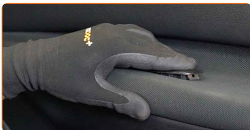
**46** Fixe o conector do vidro elétrico ao módulo do interruptor.
