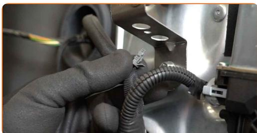
**19** Desmonte o conector do vidro elétrico. Use alicates de ponta arredondada.
