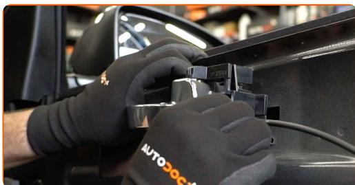
**17** Desaparafuse os fixadores do painel da porta. Use uma chave soquete nº 10. Use uma chave de catraca.
